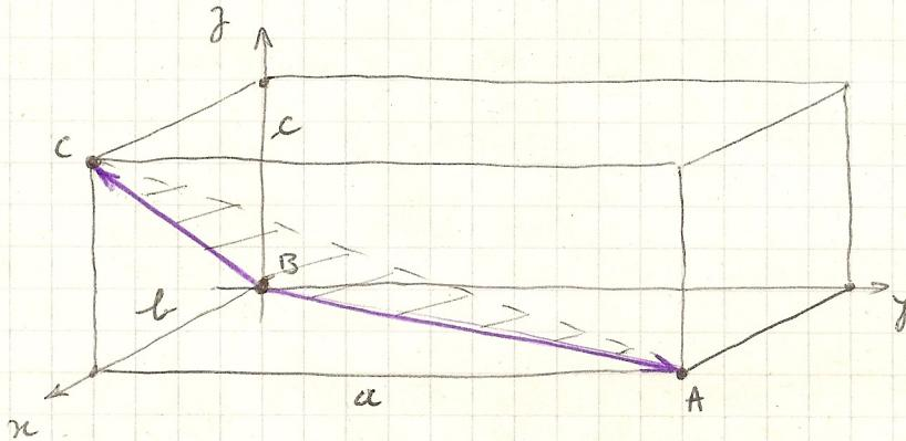
$$\vec{BC} \begin{pmatrix} b \\ 0 \\ c \end{pmatrix} \wedge \vec{BA} \begin{pmatrix} b \\ a \\ 0 \end{pmatrix} = \begin{pmatrix} -ac \\ bc \\ ab \end{pmatrix} = \vec{n}$$
